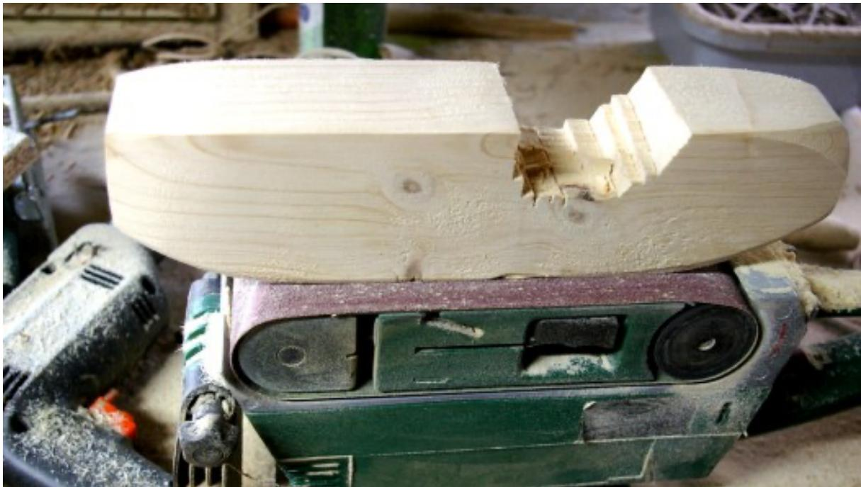
Die Sitzmulde mit einer Raspel glätten und anschließend schleifen. Wir haben dazu die Bohrmaschine mit einem Schleifaufsatz verwendet.
